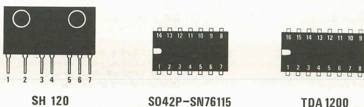
Fig. 2 Connessioni dei transistor e integrati impiegati per la realizzazione di questo progetto.
